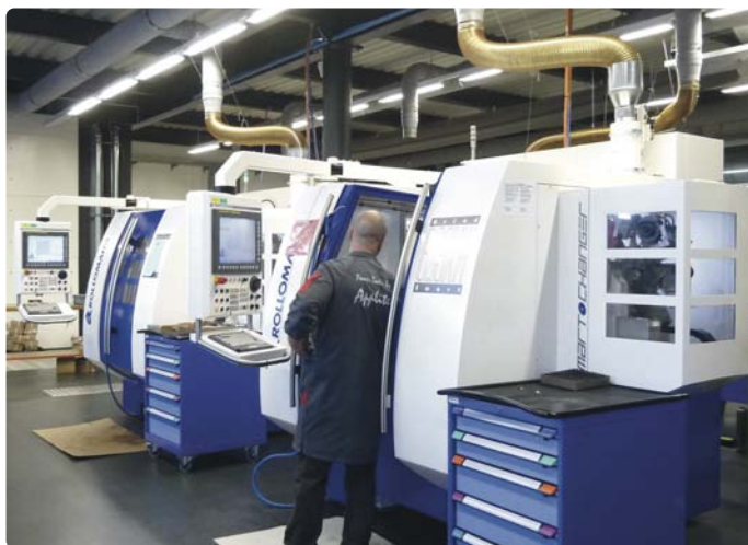
Centres de rectification d'outils Rollomatic chez Applitec à Moutier.
