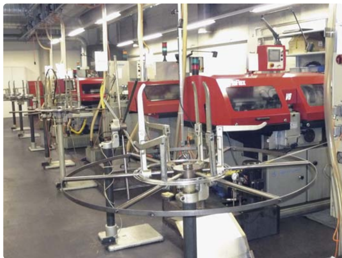
Tours automatiques (système Esco à outils tournants) chez Laubscher à Täuffelen.
