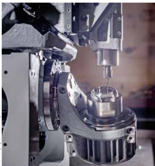
L'ensemble de la machine a été repensé et reconçu en diminuant drastiquement les masses en mouvement et les dimensions.
