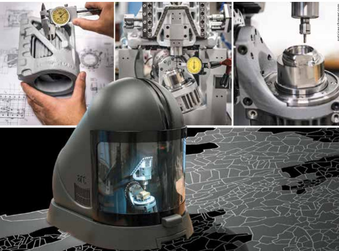
Avec la Micro5, l'usinage a été complètement repensé autour de la pièce à usiner. Par rapport à une machine classique, les masses en mouvement ont été drastiquement réduites.
